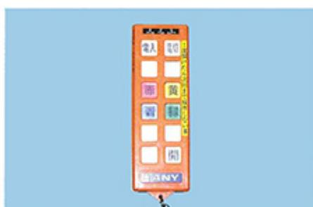
無線送信機は重さ0.5kgの押しボタン操作。無線は混信誤動作を防ぐ方式を採用し、無線作動範囲は50m、連続30時間の使用が可能。その上、「押しボタン2つ同時押し操作」システムによっても誤動作を防ぎます。
